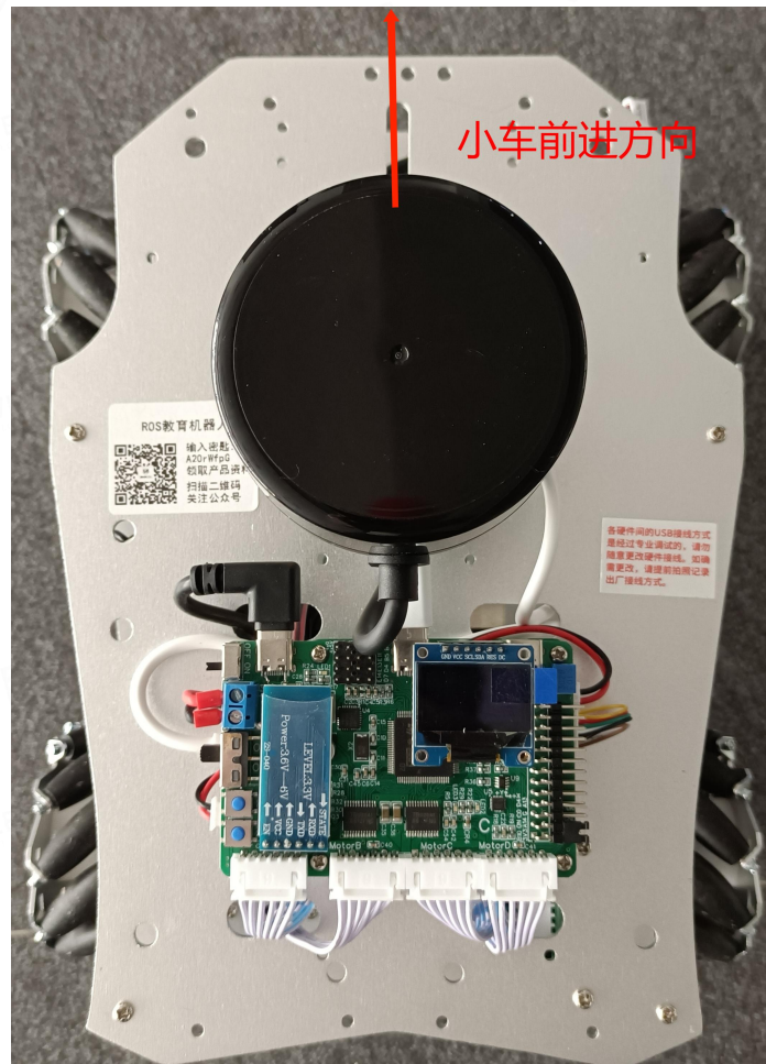
图 3-3 M10 雷达安装方向
