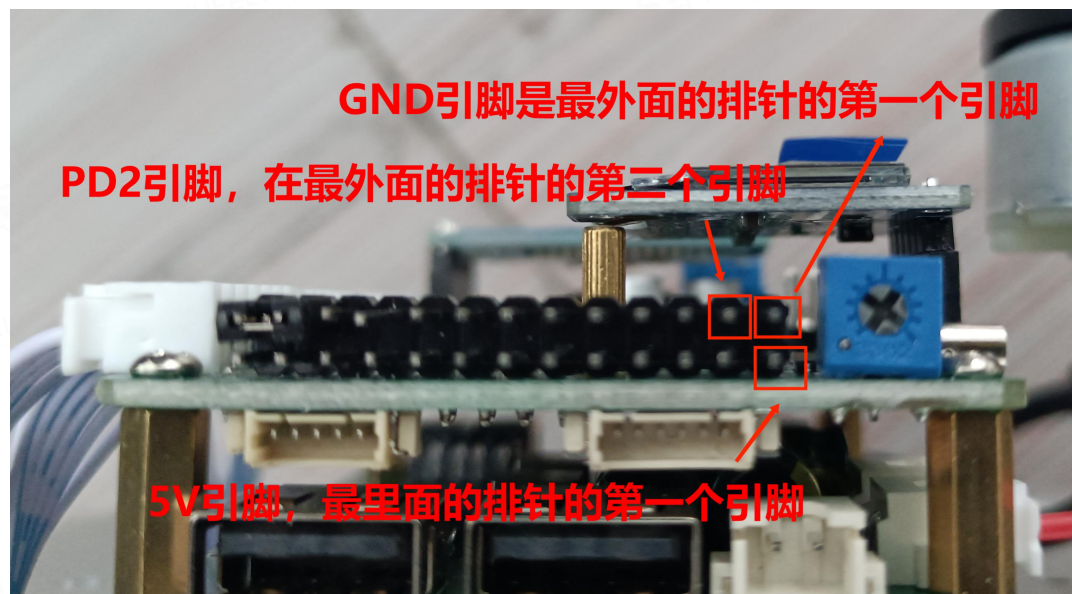
图 3-1 雷达安装接线图示
