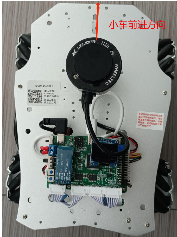
图 3-2 N10 雷达安装方向
